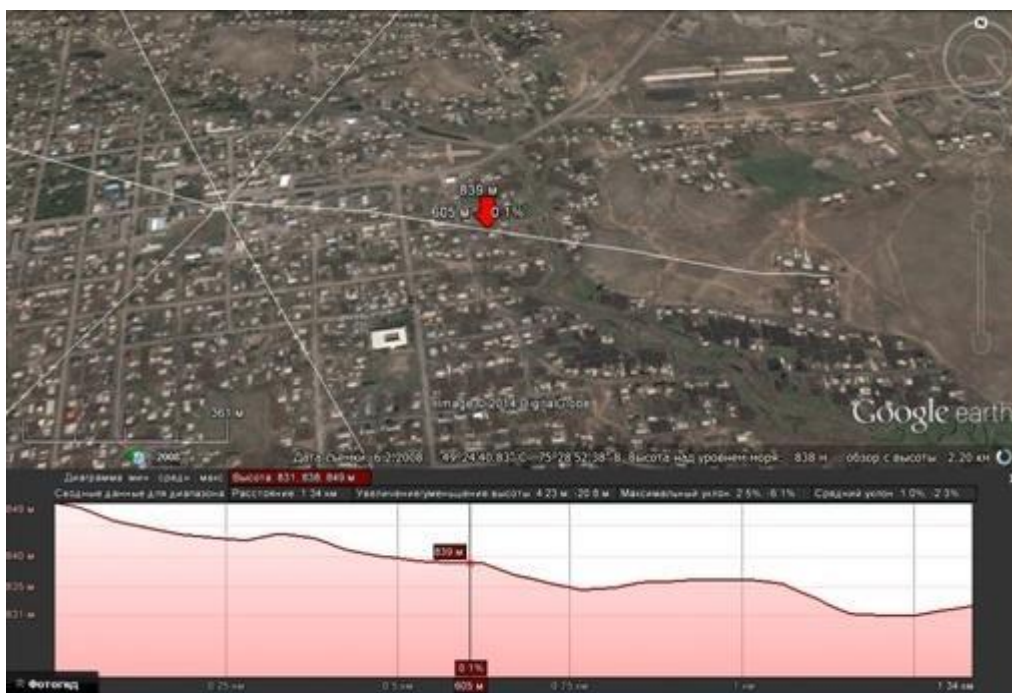
3.13-сурет – Алтыншы сектор трассасының профілі
